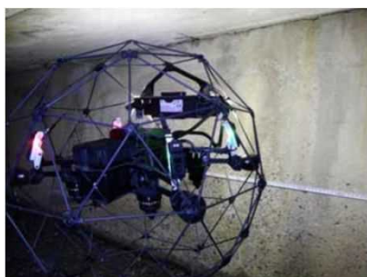
UAV（照明搭載）による撮影（R3実施）
