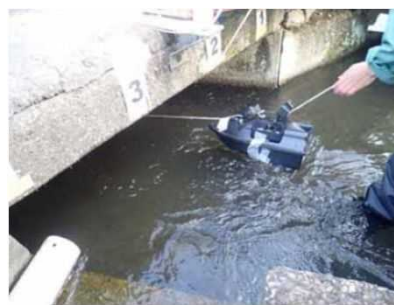
小型ボートによる撮影（R3実施）
